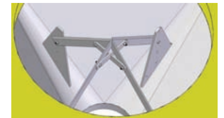
Knivkorset är demonterbart och kan enkelt justeras för att öka eller minska uppskärningen.
